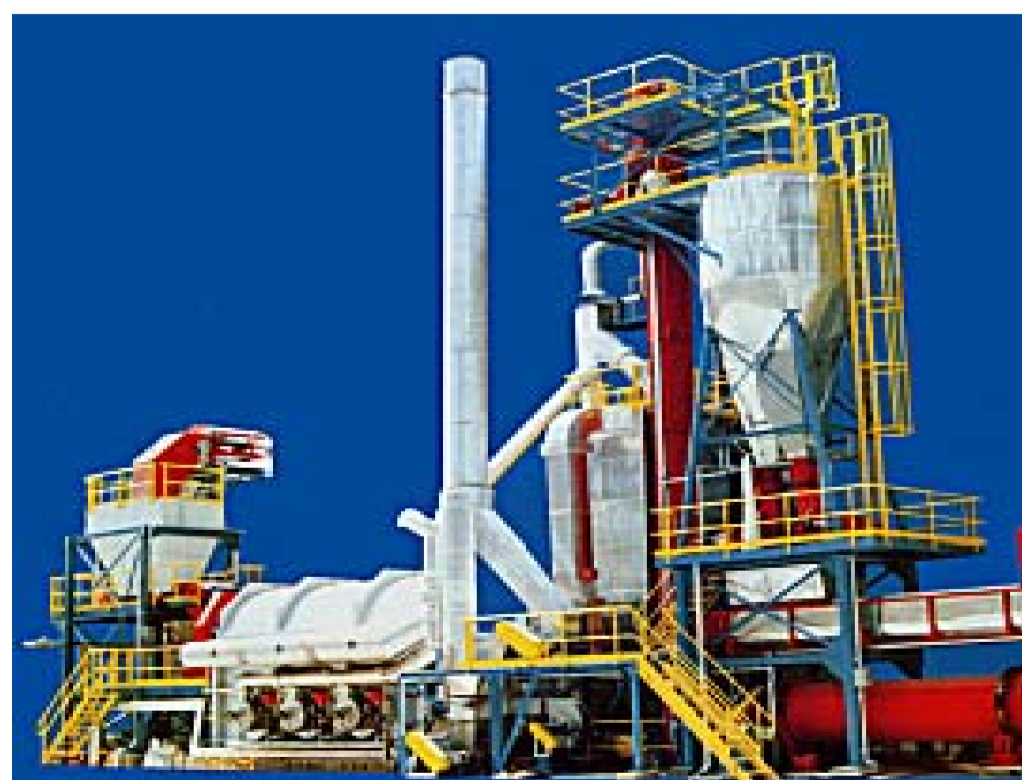
Four à plâtre GRELBEX 50—150 t/j
